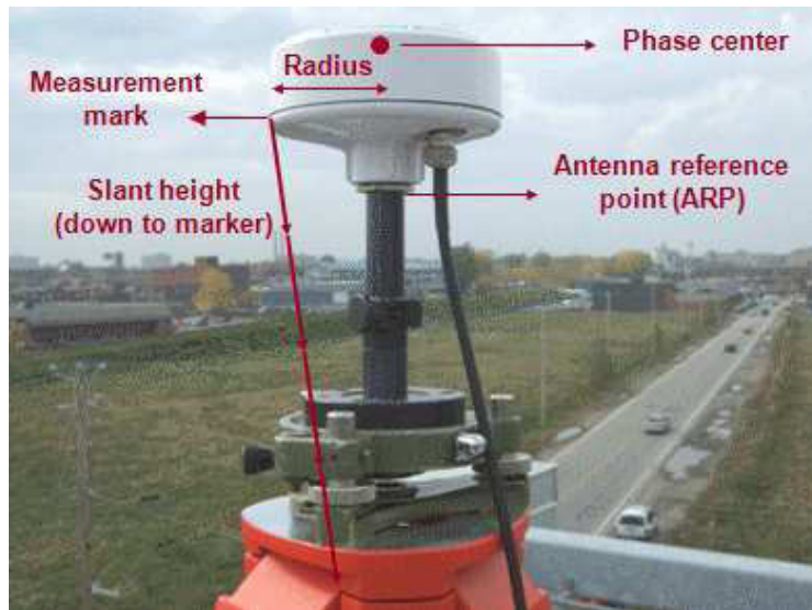
Parameters defining a GNSS antenna
